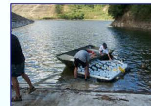
Figura 2: Instalación del perifitómetro Matlock en el Lago Cerrillos de Puerto Rico
